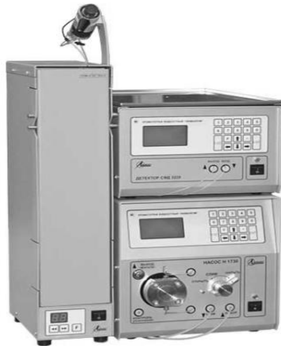
Рисунок 1 – Внешний вид хроматографа Люмахром
