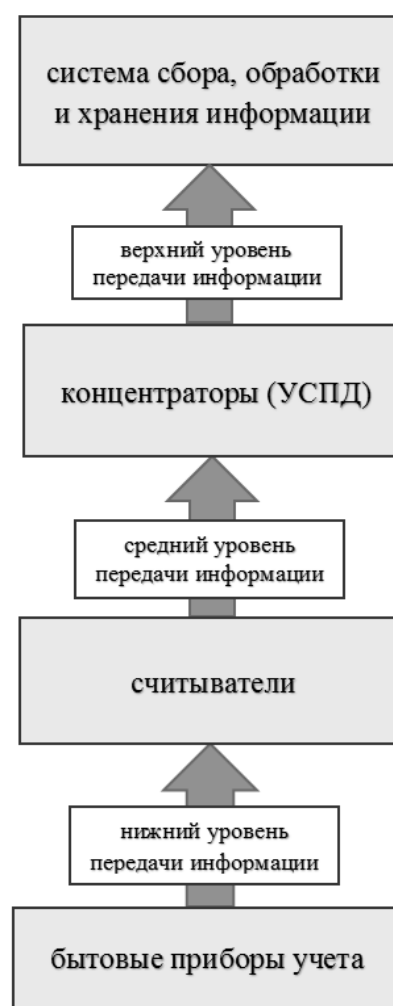
Рисунок 1 – Общая структурная схема автоматизированной системы мониторинга показаний бытовых приборов учета
