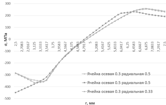
Рисунок 3 – Окружные остаточные напряжения в среднем сечении втулки
