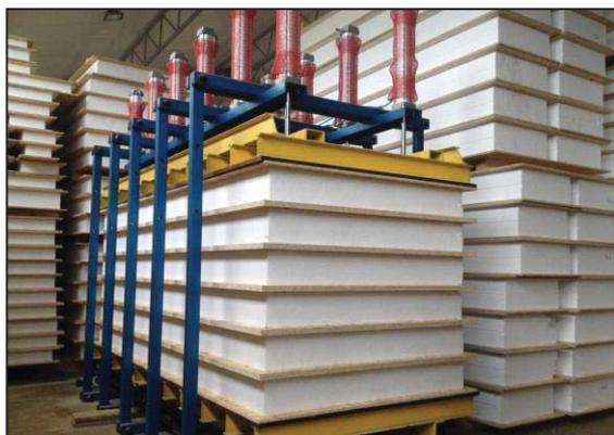
Рисунок 2 – Изготовление СИП-панелей
