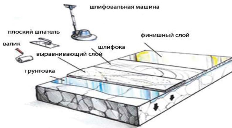
Рисунок 2 – Технологическая схема работ по монтажу наливных полов
