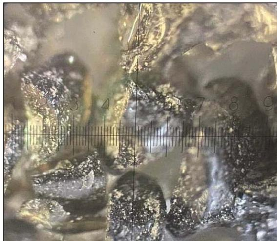
Рисунок 1 – Шлаки Абаканской ТЭС (микрофотография, цена деления 0,02 мм)
