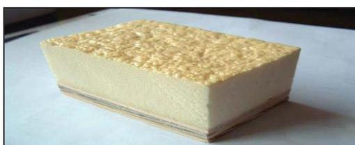
Рисунок 2 – Закрытоячеистый пенополиуретан
