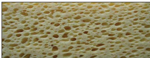
Рисунок 3 – Пенополиуретан с открыто-ячеистой структурой
