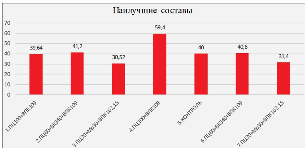
Рисунок 2 – Наилучшие показатели прочности при сжатии на 28 суток
