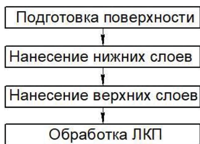
Рисунок 1 – Общая технология нанесения ЛКП
