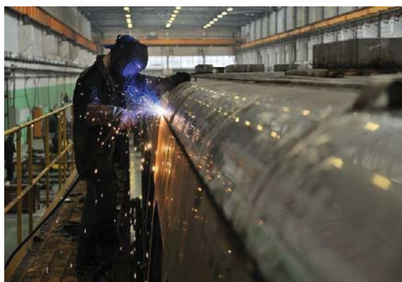
Рисунок 3 – Механизированная сварка в среде защитного газа при изготовлении вагона
