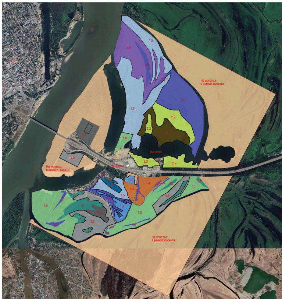
Рисунок 1 - Карта уровня и площади засыпания грунтом на правом берегу г. Барнаула: 1,0; 1,4; 1,5 и др. – уровень, указанный в м, который необходимо засыпать до отметки неподтопляемости и незатопляемости
