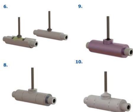
Рисунок 5 – Этапы монтажа и фиксации аэрогелевого мата на трубопроводе фланцевого типа
