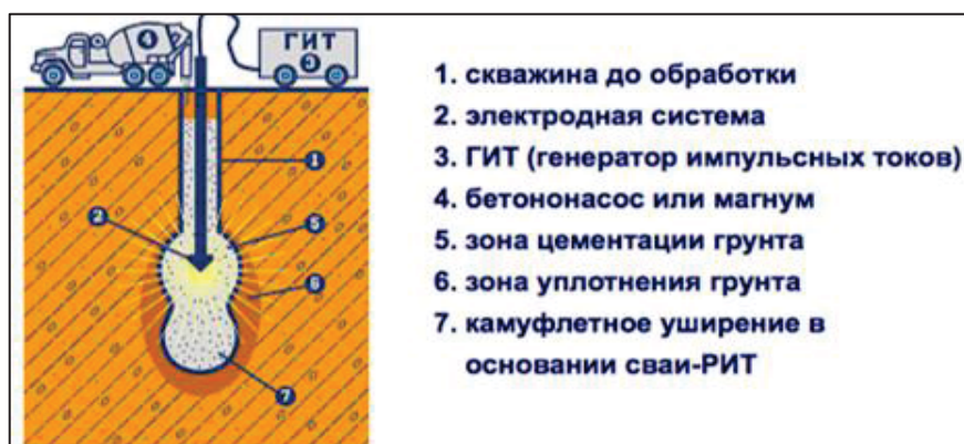
Рисунок 2 – Схема устройства свайного фундамента по разрядно-импульсной технологии
