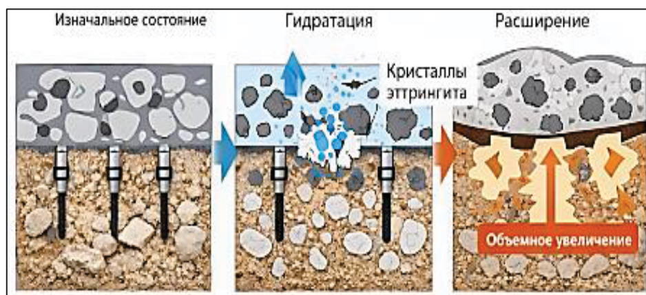
Рисунок 2 – Механизм расширения саморасширяющегося раствора
