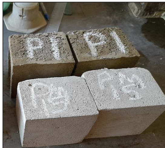
Рисунок 2 – Сравнение цветов образцов газобетона (без мела / с 15% мела)
