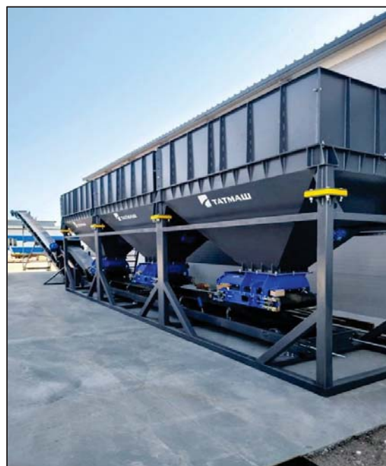
Рисунок 1 – Смесительная установка для изготовления ПСС
