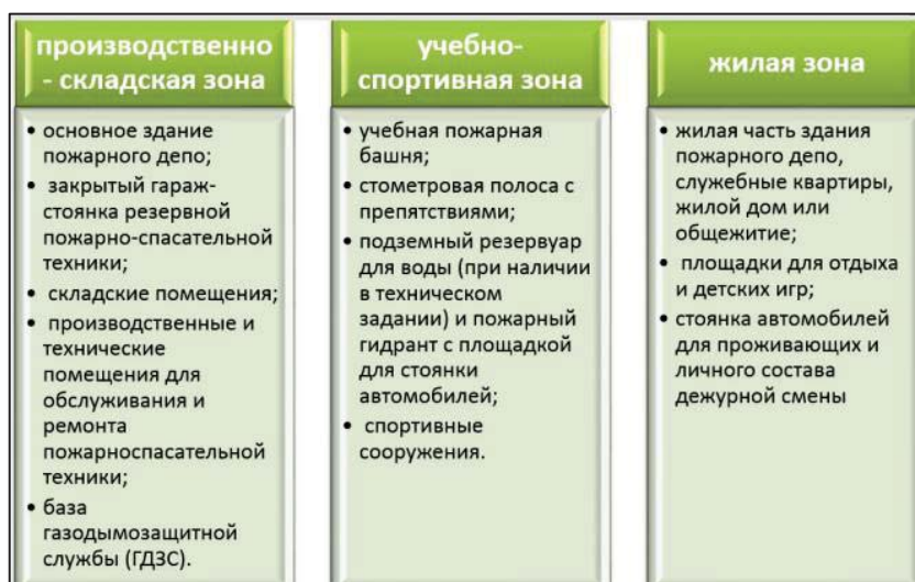
Рисунок 4 – Основное зонирование пожарных депо
