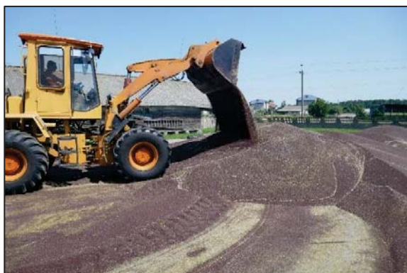
Рисунок 2 – Смешивание ПСС фронтальным погрузчиком
