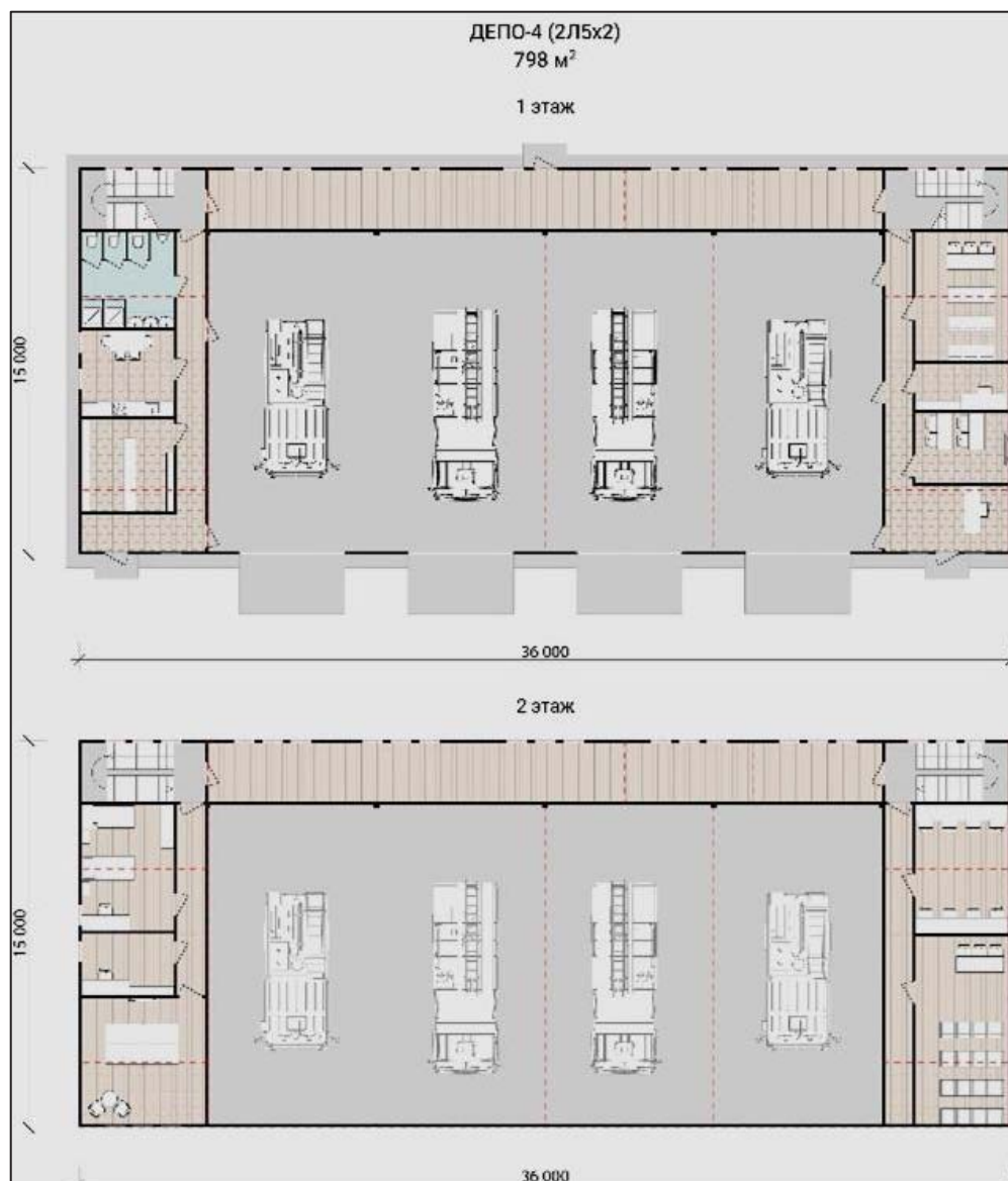
Рисунок 5 – Пример модульного быстровозводимого пожарного депо на 4 выезда
