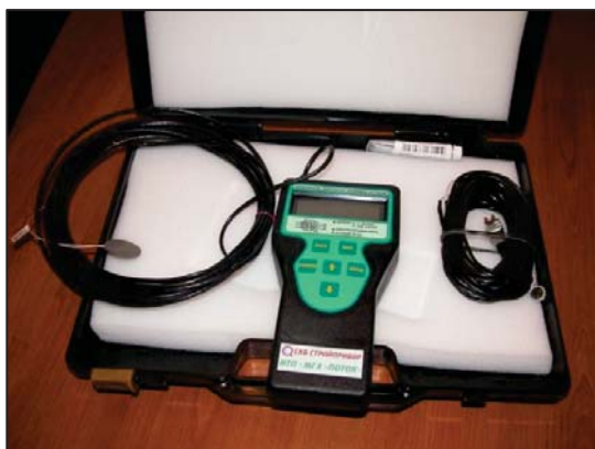
Рисунок 1 – Измеритель плотности тепловых потоков и температур И ТП МГ 4 «Поток»
