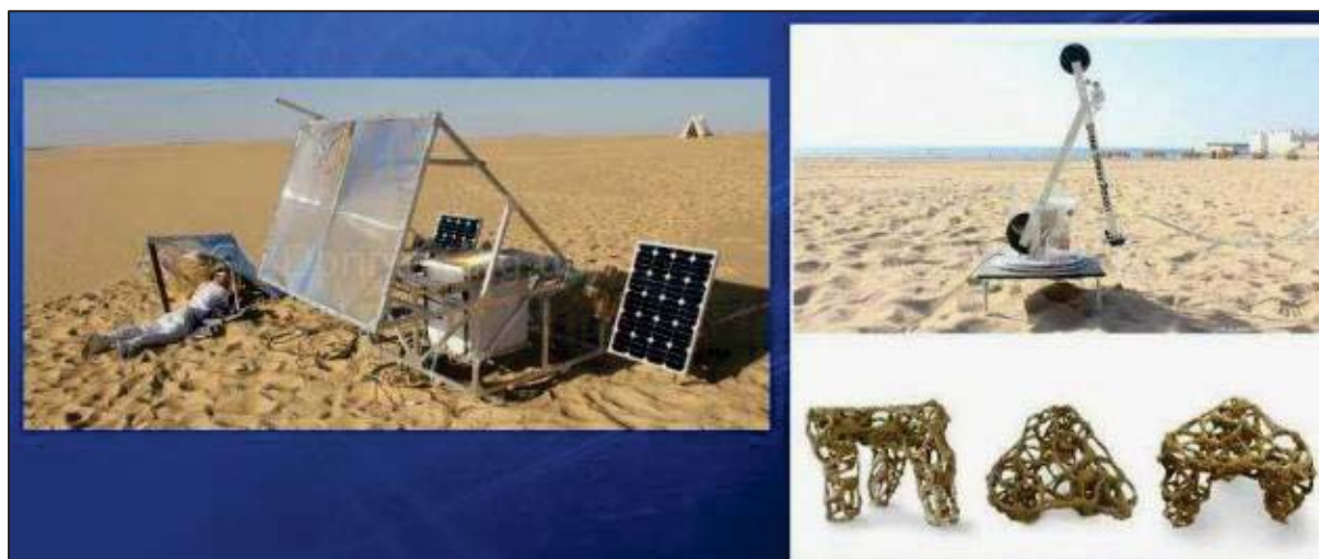
Рисунок 5 – Метод спекания (селективного спекания) с помощью 3D-принтера
