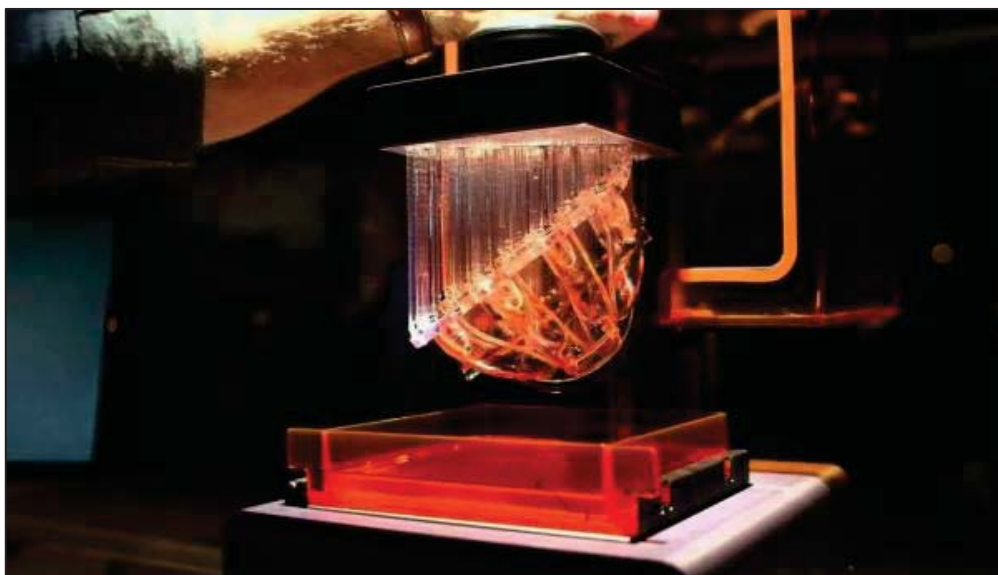
Рисунок 6 – Лазерная стереолитография с помощью 3D-принтера
