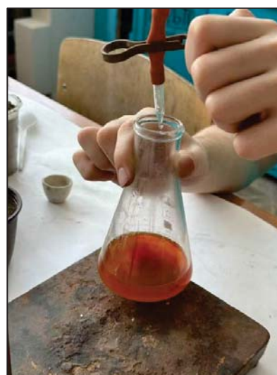
Рисунок 4 – Определение свободного оксида кальция
