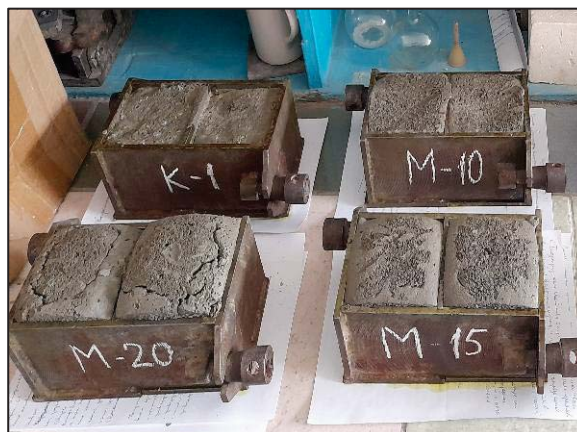
Рисунок 3 – Фото оседания газомассы различных составов
