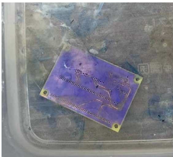
Рисунок 2 – Плата в растворе для снятия фоторезиста
